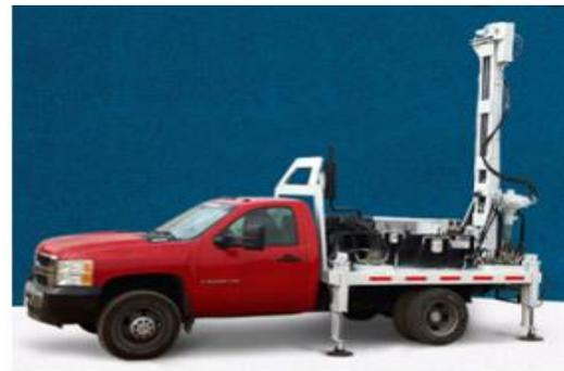
**Figura 7-17 Equipos tipo que se podrán utilizar para la perforación del pozo de agua subterránea**
