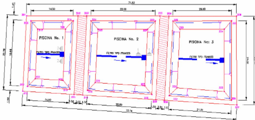
**Figura 7-26 Distribución de las Piscinas en Sistema Dewatering**
