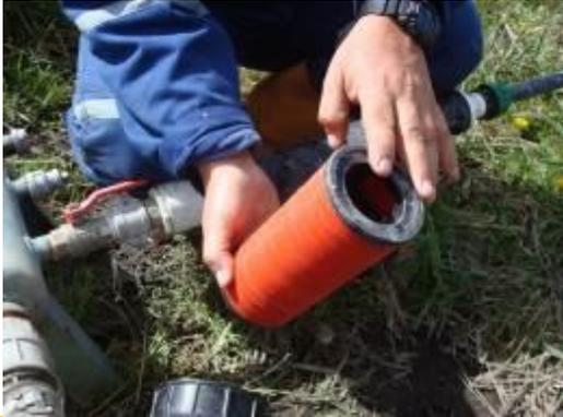
Fotografía 7-12 Revisión de elementos y empaques de los filtros
